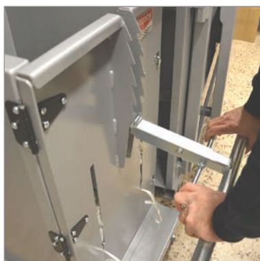
De persstempel blijft automatisch in de laagste stand staan, hierdoor blijft het materiaal in elkaar gedrukt.
