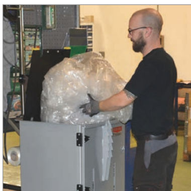
Makkelijk te vullen met materiaal. Persstempel wordt naar beneden gedrukt.
